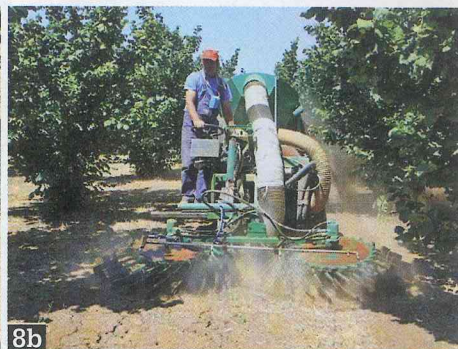
Foto 8a e 8b Immagini relative a sviluppi successivi del prototipo: applicazione di una barra irroratrice posta sopra i ranghinatori rotanti della testata di raccolta
