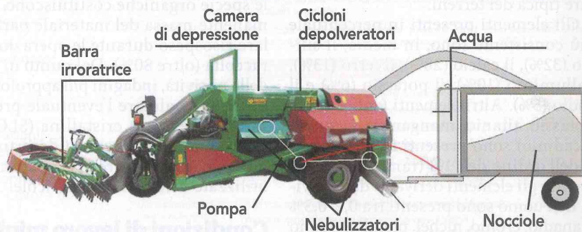
FIGURA 1 - Schema del sistema di abbattimento polveri su Facma 300 S
