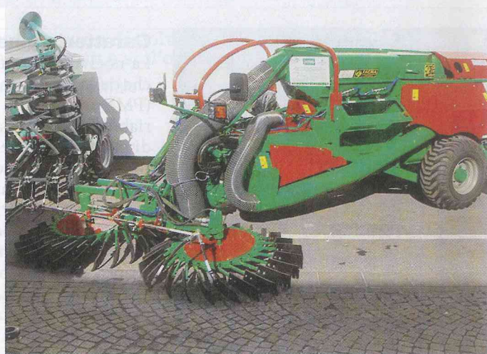
Foto 2 Raccogliatrice pneumatica (aspiratrice) Facma Cimina mod. 300 S, esposta all'ultima edizione di Eima International
