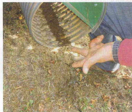
Foto 7 Fluido fangoso in uscita dal condotto di efflusso
