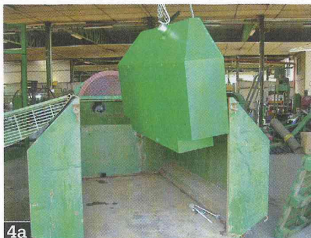
Foto 4a e 4b Inserimento del serbatoio supplementare nel carrello di stoccaggio
