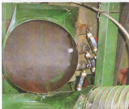
Foto 6 Acqua nebulizzata nel condotto di efflusso
