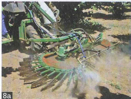
Foto 8a e 8b Immagini relative a sviluppi successivi del prototipo: applicazione di una barra irroratrice posta sopra i ranghinatori rotanti della testata di raccolta
